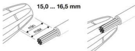
Länge der freiliegenden Drähte am Stecker überprüfen.
