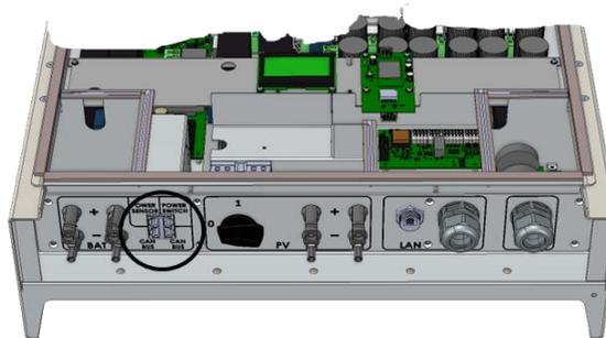
Stecken Sie das Kabel in die RJ45-Steckverbindung (CAN) ein.
