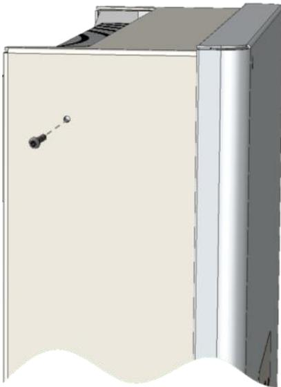
Lösen Sie die Sicherungsschrauben des Wechselrichters oben auf der linken und rechten Seite.
