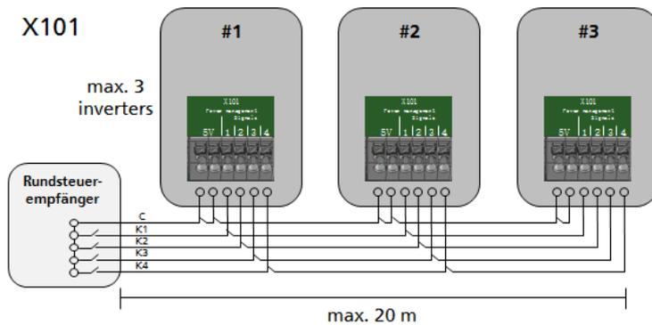
Abb. 6-5 Anschluss Rundsteuerempfänger
