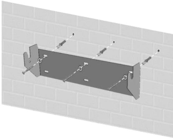
Montieren Sie die Wandhalterung mit den entsprechenden Dübeln, Unterlegscheiben (Außen-  $\varnothing$  min. 18mm) und mind. 3 Schrauben ( $\varnothing$  6-8mm).
