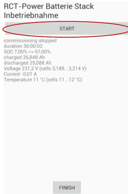
Der bestehende Batterieturm wird nun vollgeladen (100%) und danach selbstständig wieder auf einen SOC von 50% entladen.
