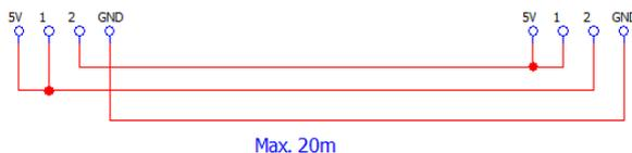
Die maximale Leitungslänge beträgt 20 Meter.
