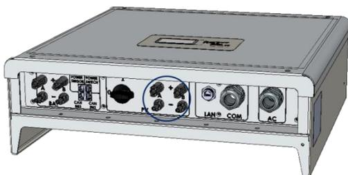
Stellen Sie sicher, dass der DC-Schalter auf „0“ steht, dann stecken Sie die entsprechenden Plus- und Minuspole an die DC Eingänge des Wechselrichters an.
