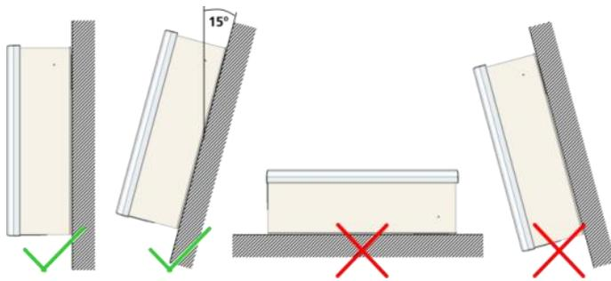
Montieren Sie den Wechselrichter in aufrechter oder leicht nach hinten geneigter Position auf.
