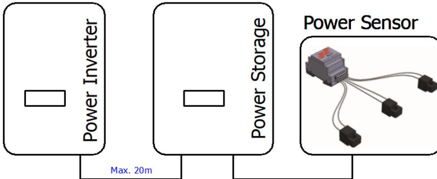
Die maximale Leitungslänge beträgt 20 Meter.
