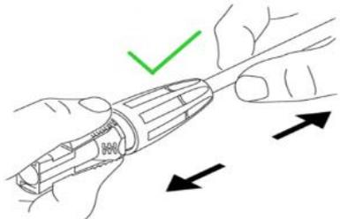
Prüfen Sie die korrekte Einrastung durch einen leichten Zug am Kabel.
