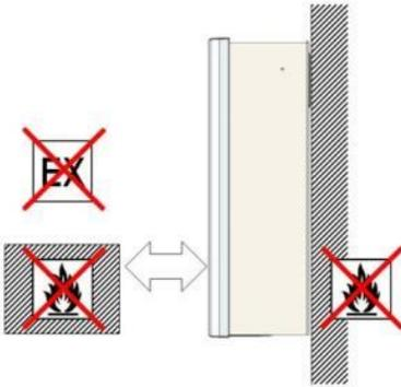
Der Montageuntergrund muss aus flammhemmendem Werkstoff bestehen. Nicht in explosionsgefährdeten Räumen installieren. Fernhalten von brennbaren Materialien.
