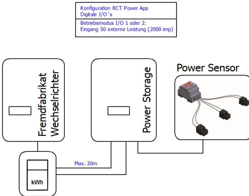
Die maximale Leitungslänge beträgt 20 Meter.
