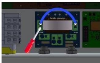
Entfernen Sie die Abdeckung des Wechselrichters. Halten Sie Ausschau nach den Klemmen für den Parallel Betrieb.
