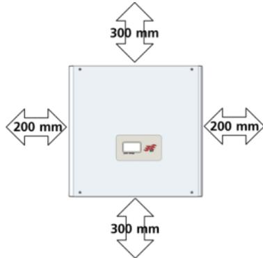
Mindestabstände um eine ausreichende freie Konvektion zu ermöglichen.
