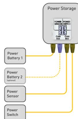
Zusätzliche Power Switch und Power Sensor Kommunikation
