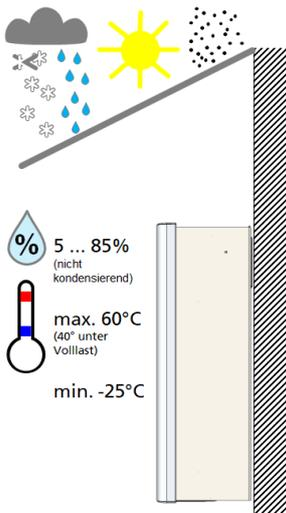
Der Wechselrichter muss geschützt sein vor Schnee, Regen, direkter Wärmestrahlung (z.B. Sonne, Heizung etc.) und Staub.
